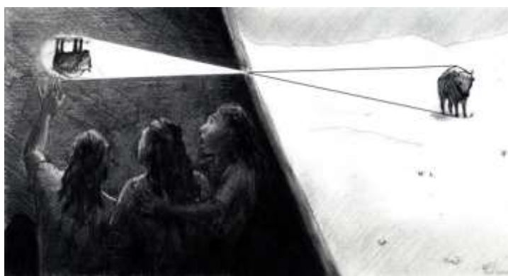
fig. 1: Formarea naturală unei imagini după principiul camerei
